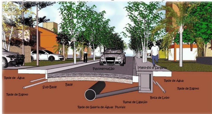
Figura 23: Estrutura para drenagem urbana de águas pluviais
