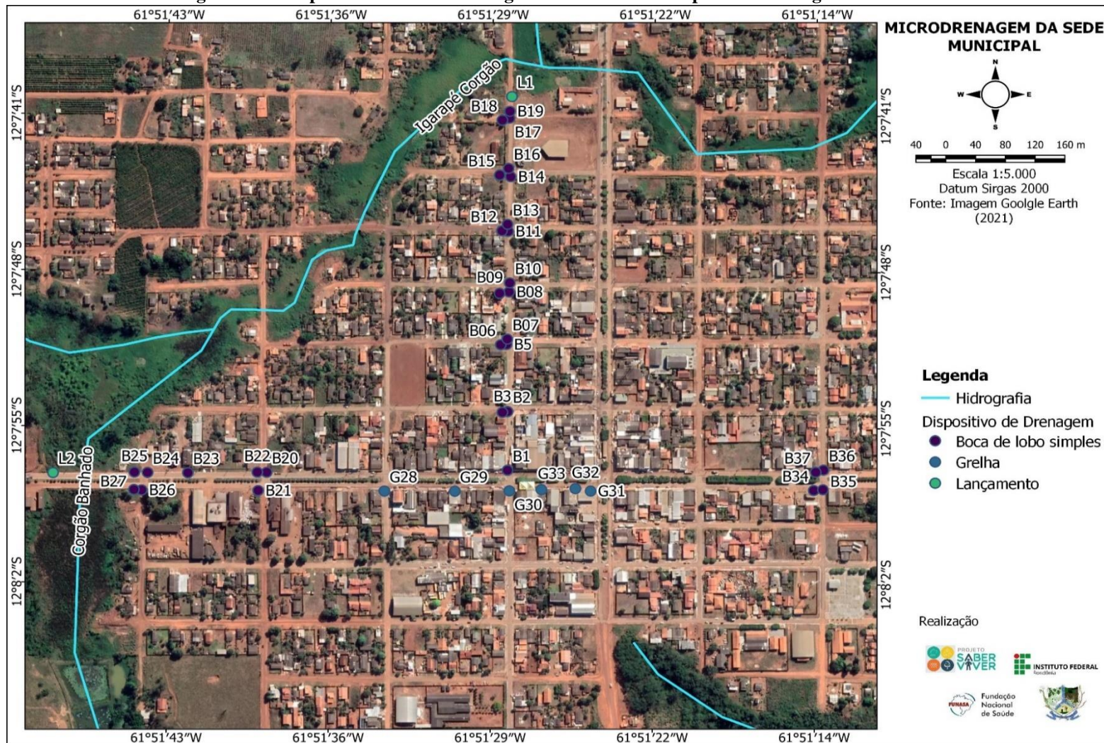
Figura 203 - Dispositivos de Microdrenagem na Sede do Município de Alto Alegre dos Parecis.
