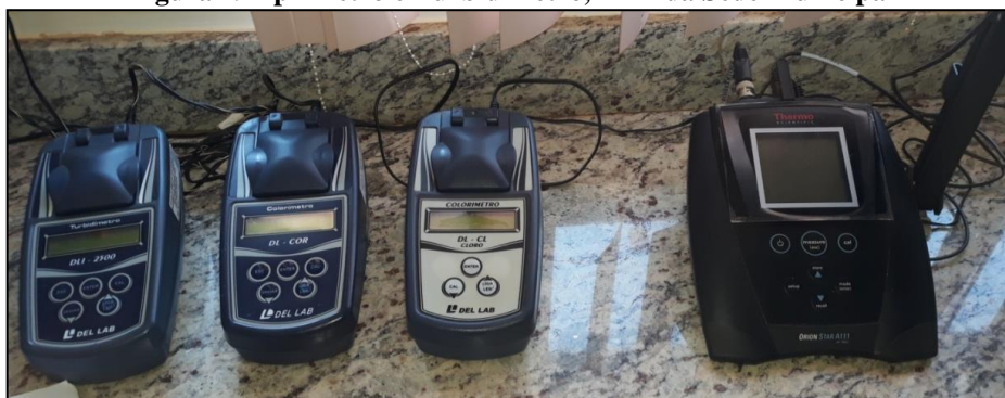
Figura 79 - pHmetro e Turbidímetro, ETA da Sede Municipal
