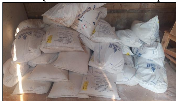
Produtos Químicos: Sulfato de Alumínio e Hipoclorito de Cálcio.
