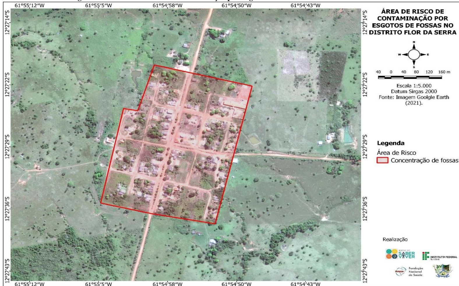
Figura 180 - Área com Risco de Contaminação por Esgotos de Fossas no Distrito de Flor da Serra.
