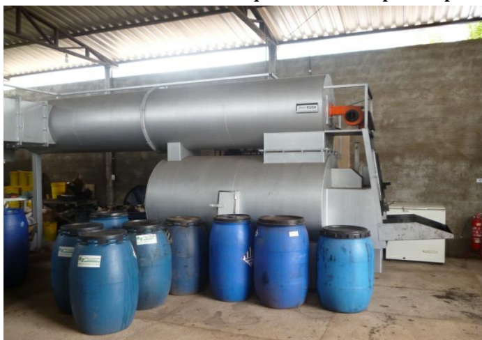
Figura 214 - Incinerador utilizado na queima dos RSS pela empresa M.X.P
