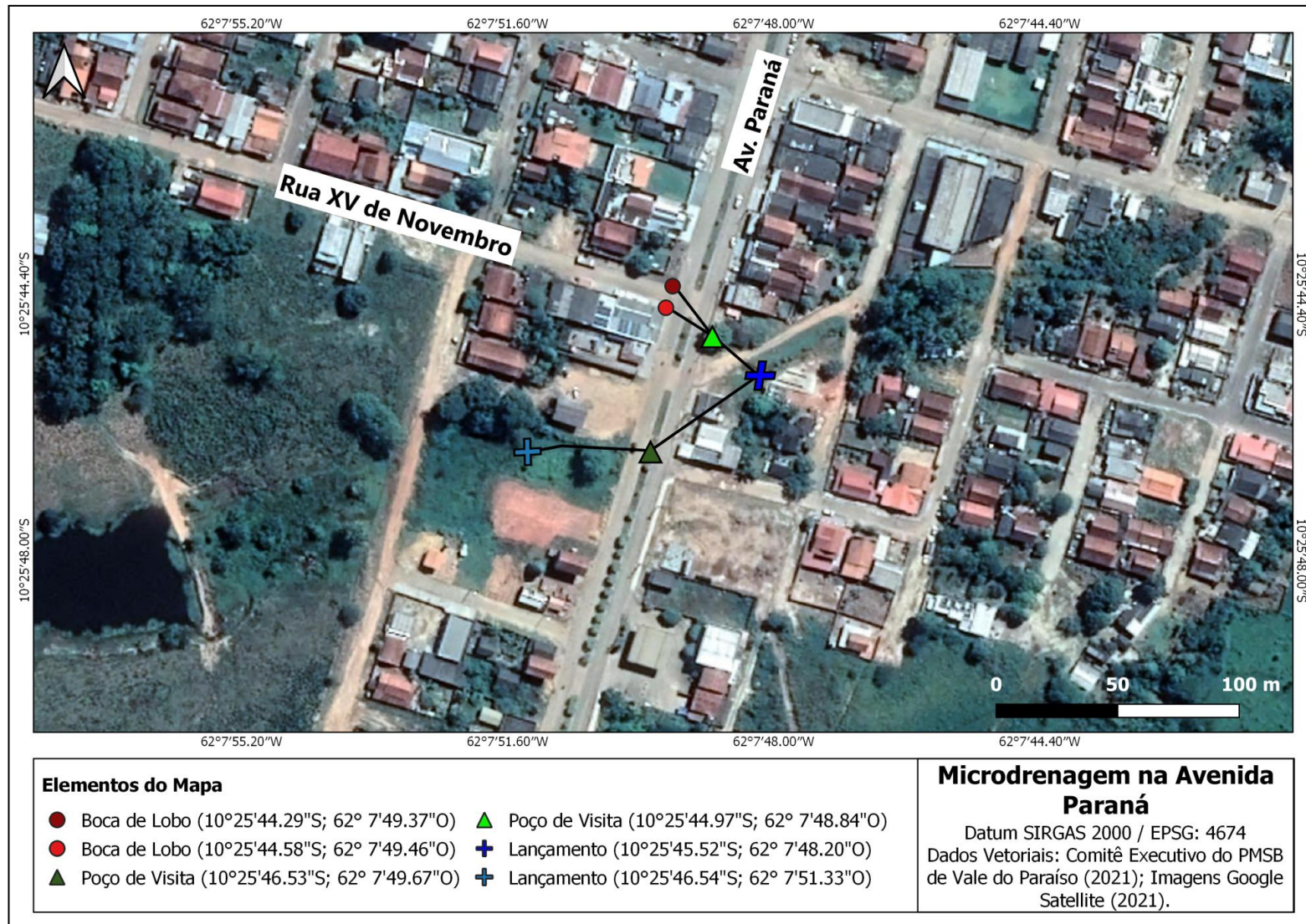
Figura 159 - Localização das Bocas de Lobo na Avenida Paraná
