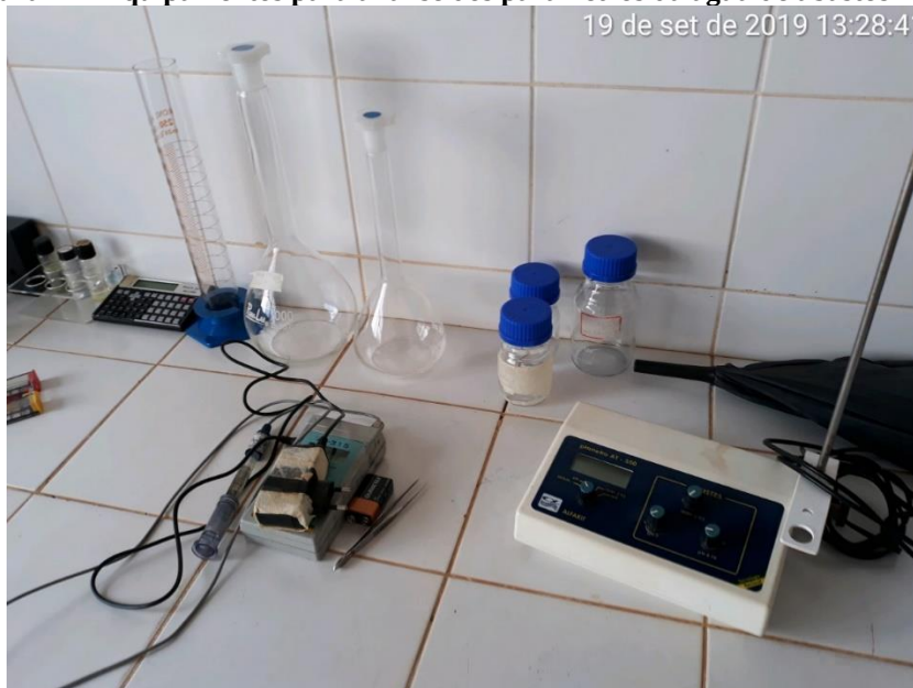
Figura 77 - Equipamentos para análise dos parâmetros da água de abastecimento
