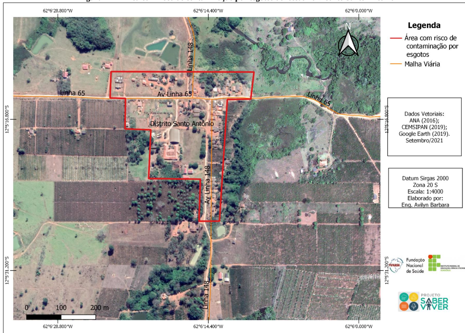
Figura 172 - Área com risco de contaminação por esgotos de fossas no Distrito Santo Antônio
