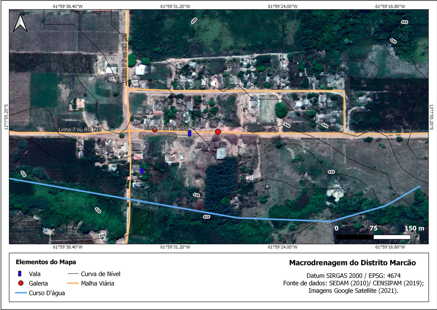
Figura 196 - Macrodrenagem no Distrito Marcão.
