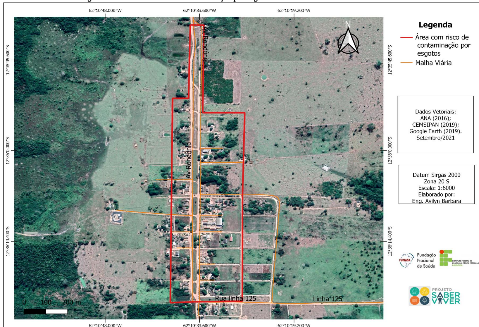
Figura 174 - Área com risco de contaminação por esgotos de fossas no Distrito Izidolândia
