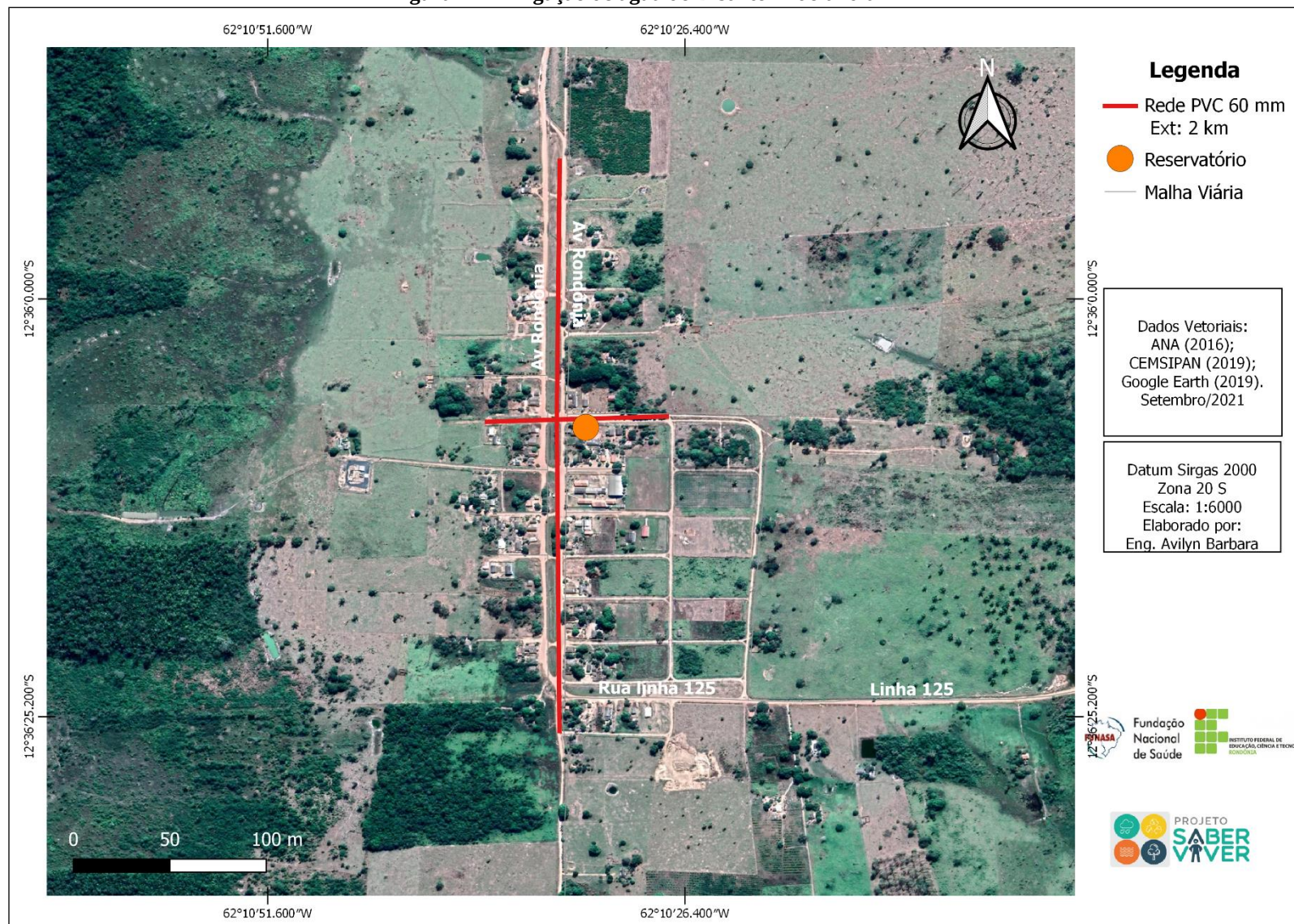
Figura 141 – Ligação de água do Distrito Izidolândia
