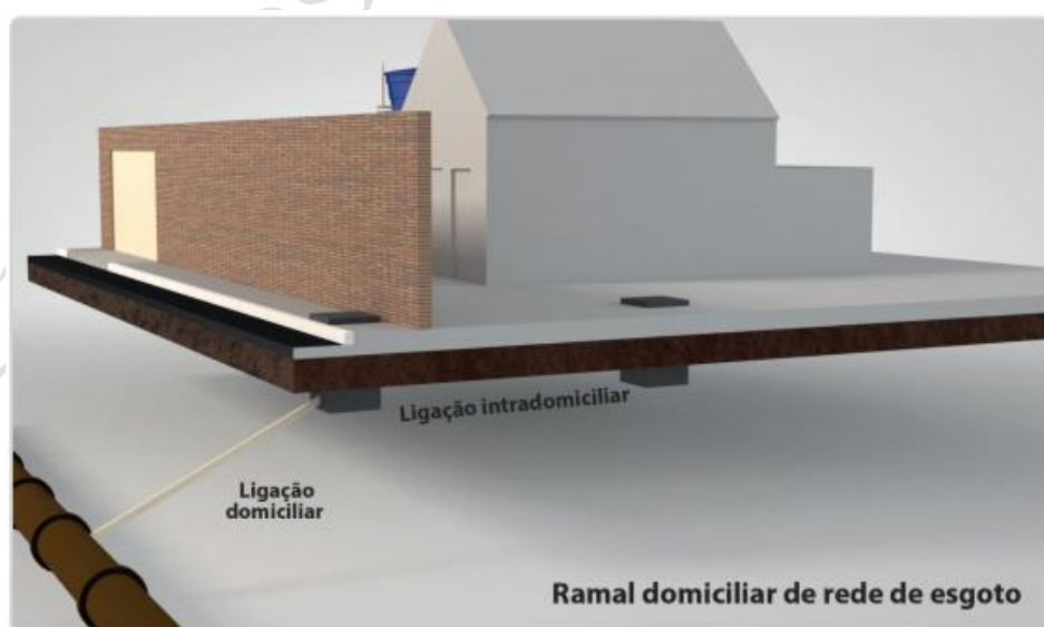
Figura 16— Esquema da ligação domiciliar de esgoto.
