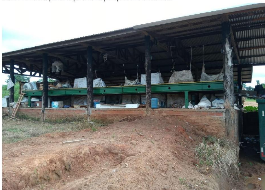
Esteira Rolante utilizada no processo de separação dos recicláveis
