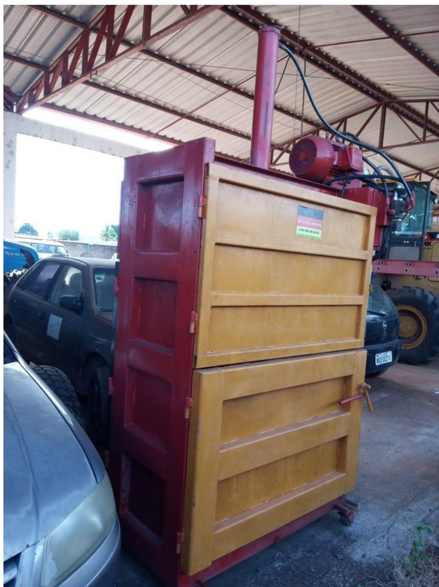
Prensa para compactar os recicláveis para melhoria no armazenamento e transporte
