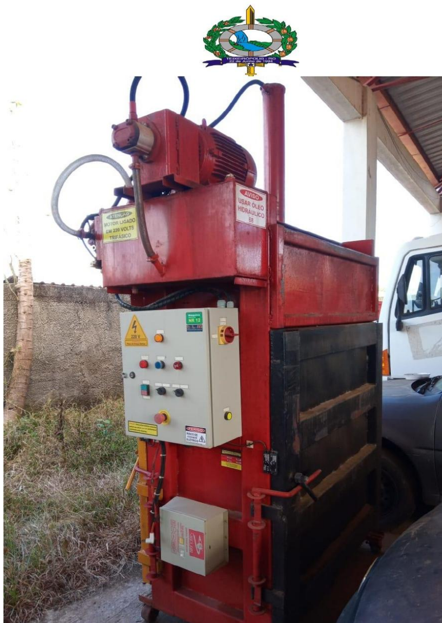
Prensa para compactar os materiais recicláveis para armazenamento e transporte
