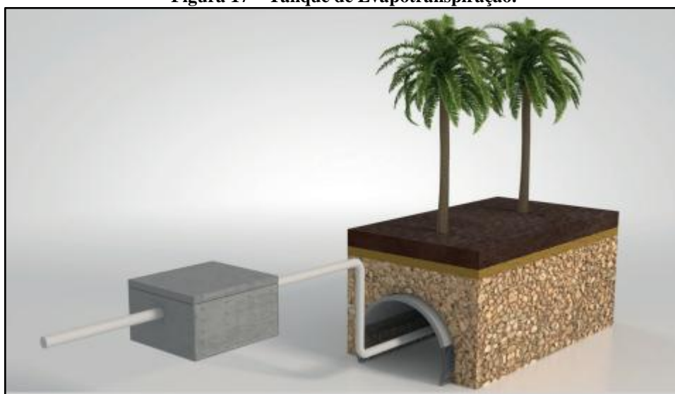
Figura 17—Tanque de Evapotranspiração.
