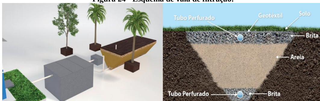
Figura 24 - Esquema de vala de filtração.
