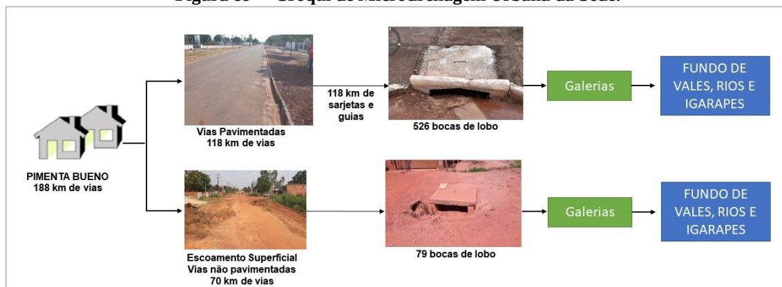
Figura 89— Croqui de Microdrenagem Urbana da Sede.
