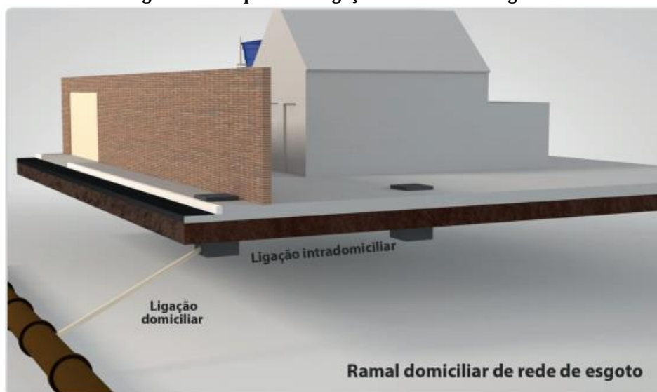
Figura 20 - Esquema da ligação domiciliar de esgoto.
