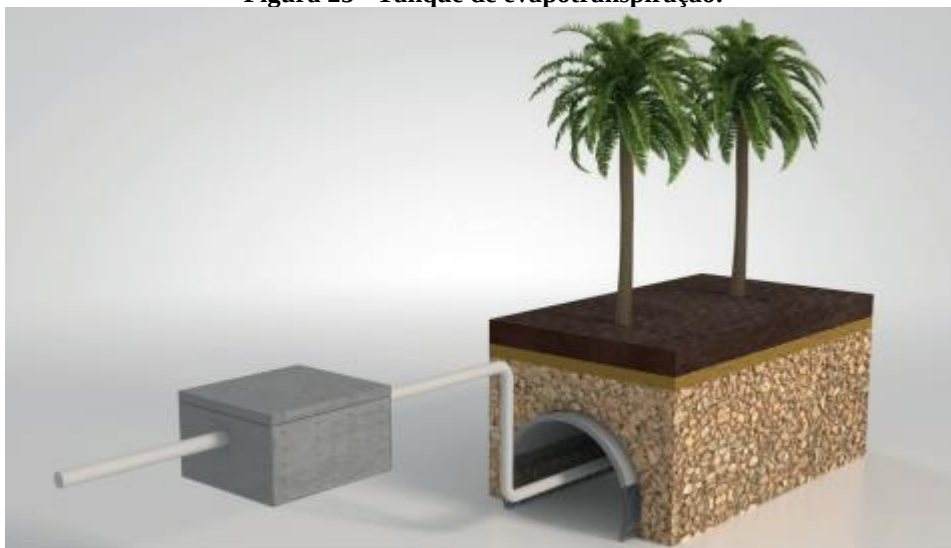
Figura 25 - Tanque de evapotranspiração.
