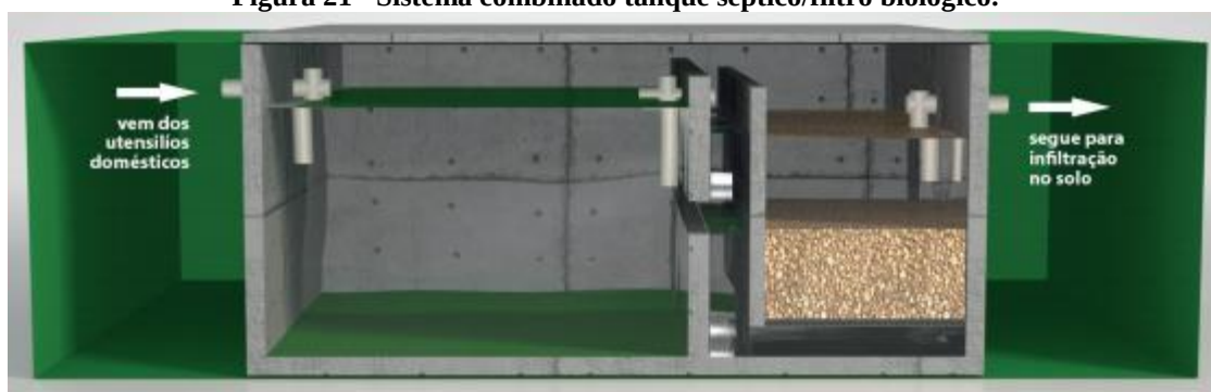
Figura 21 - Sistema combinado tanque séptico/filtro biológico.
