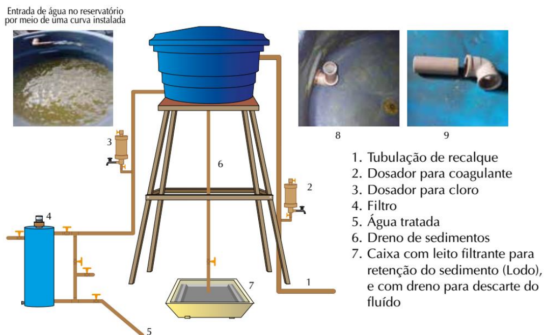
Figura 10 - Solução Alternativa de Tratamento de Água (SALTA-z).
