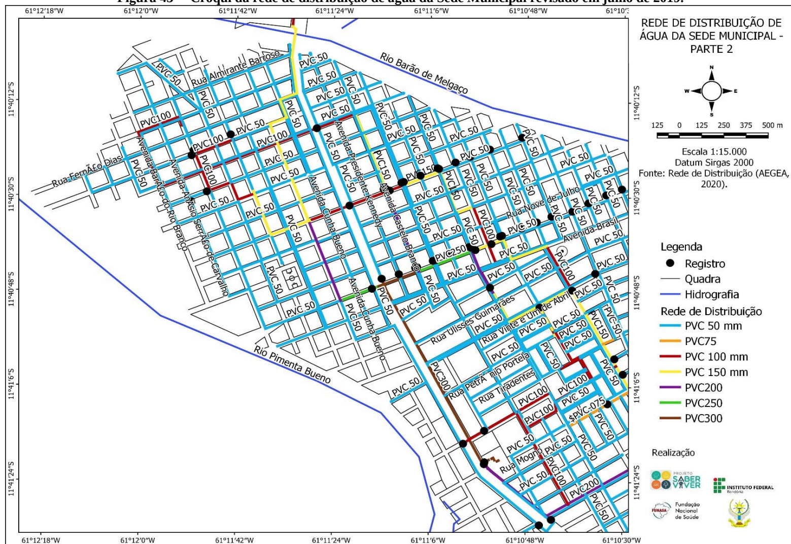
Figura 43— Croqui da rede de distribuição de água da Sede Municipal revisado em julho de 2019.
