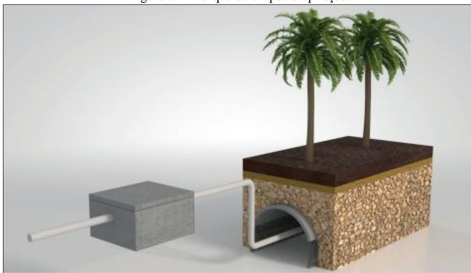
Figura 7 — Tanque de evapotranspiração.
