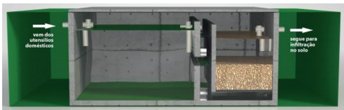
Figura 16—Sistema combinado tanque séptico/filtro biológico
