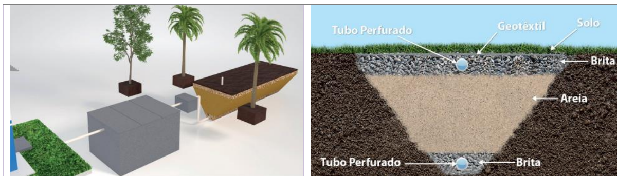
Figura 19—Esquema de vala de filtração
