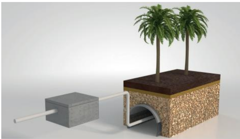
Figura 20—Tanque de evapotranspiração
