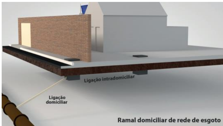
Figura 15—Esquema da ligação domiciliar de esgoto
