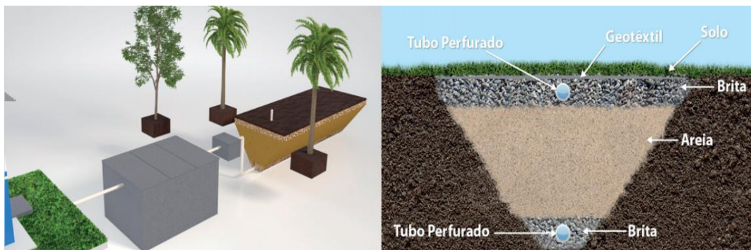
Figura 16 - Esquema de vala de filtração.
