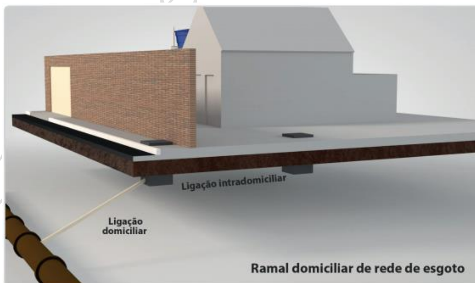
Figura 16— Esquema da ligação domiciliar de esgoto.
