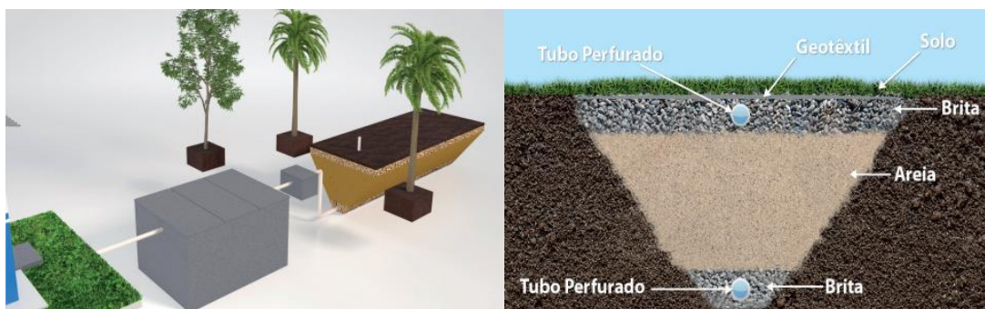
Figura 20 – Esquema de vala de filtração
