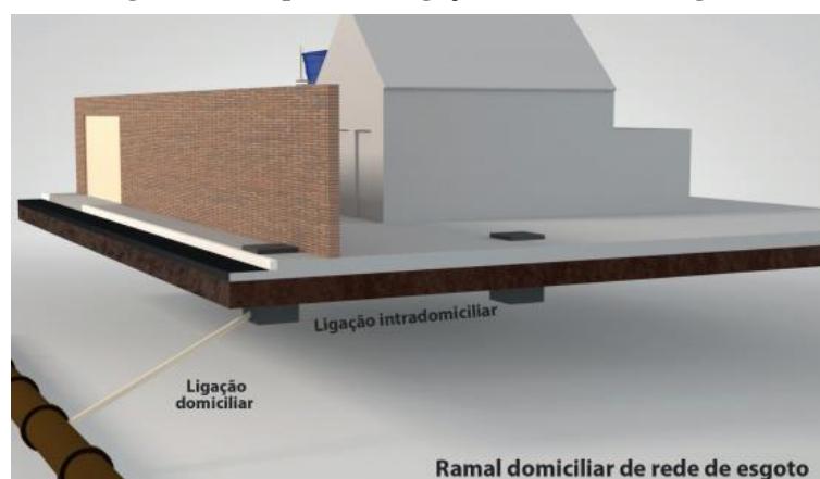
Figura 12 - Esquema da ligação domiciliar de esgoto
