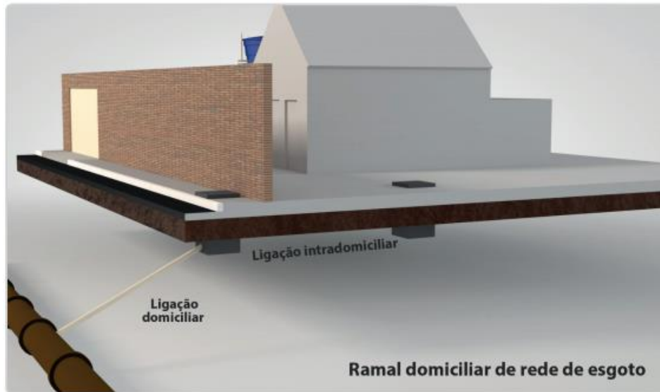
Figura 20 - Esquema da ligação domiciliar de esgoto.
