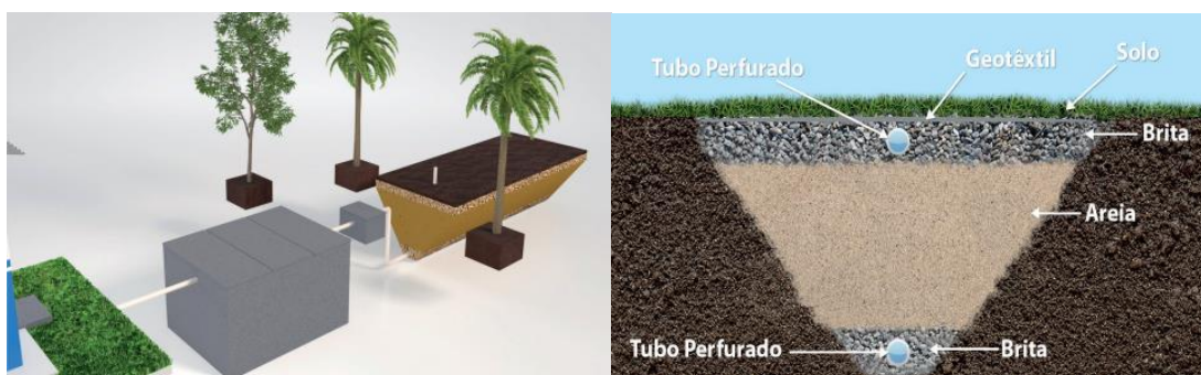
Figura 24 - Esquema de vala de filtração.
