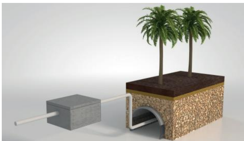
Figura 25 - Tanque de evapotranspiração.
