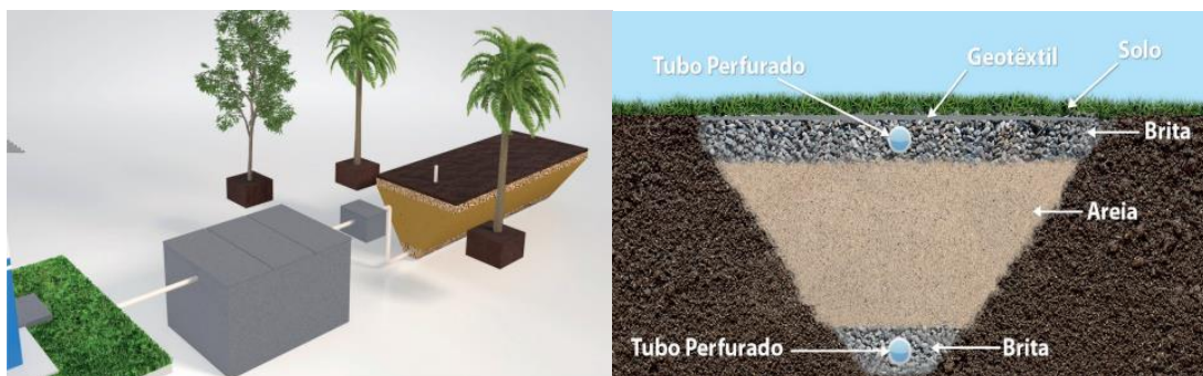
Figura 24 - Esquema de vala de filtração.
