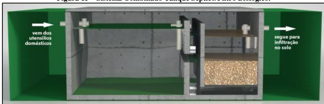
Figura 15—Sistema Combinado Tanque Séptico/Filtro Biológico.
