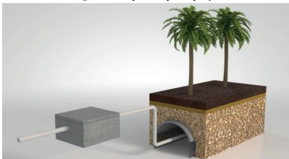
Figura 23 - Tanque de evapotranspiração
