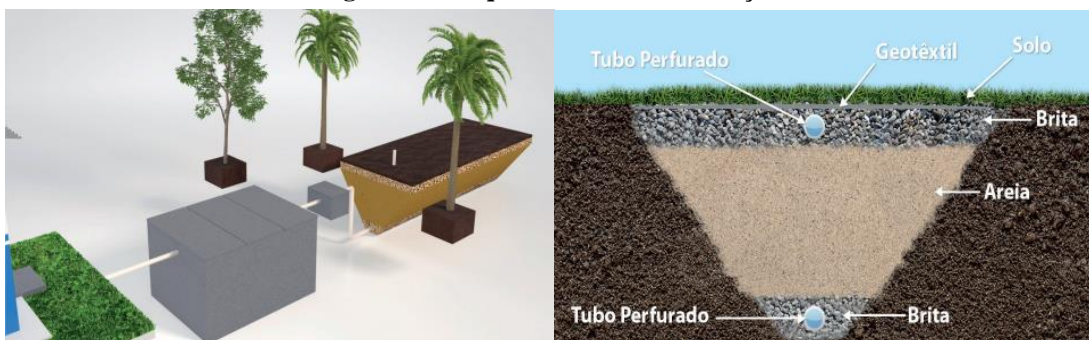
Figura 22 - Esquema de vala de filtração
