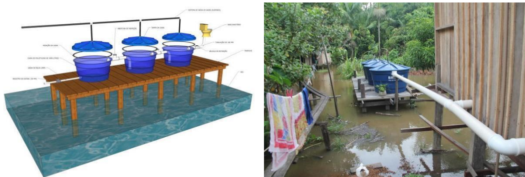
Figura 17- Fossas Altas Comunitárias, instaladas em áreas ribeirinhas.
