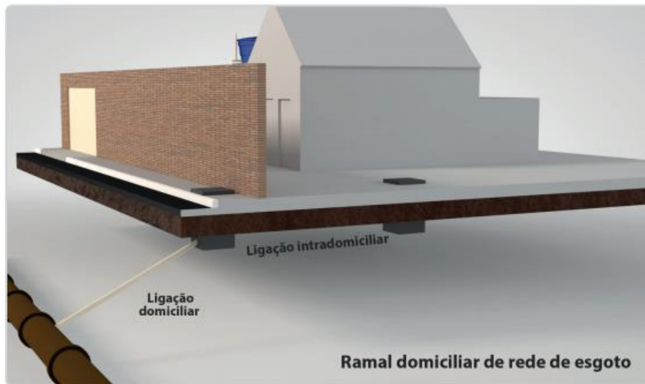
Figura 18 - Esquema da ligação domiciliar de esgoto
