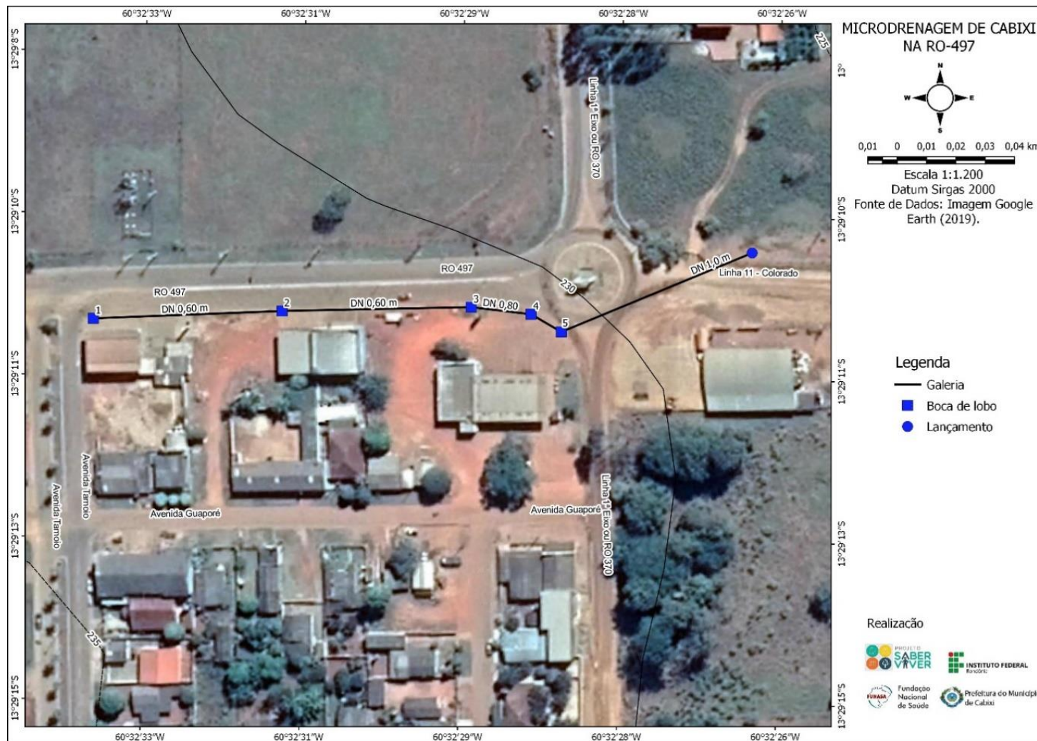
Figura 186 - Trecho com cobertura por bocas de lobo na RO-497.
