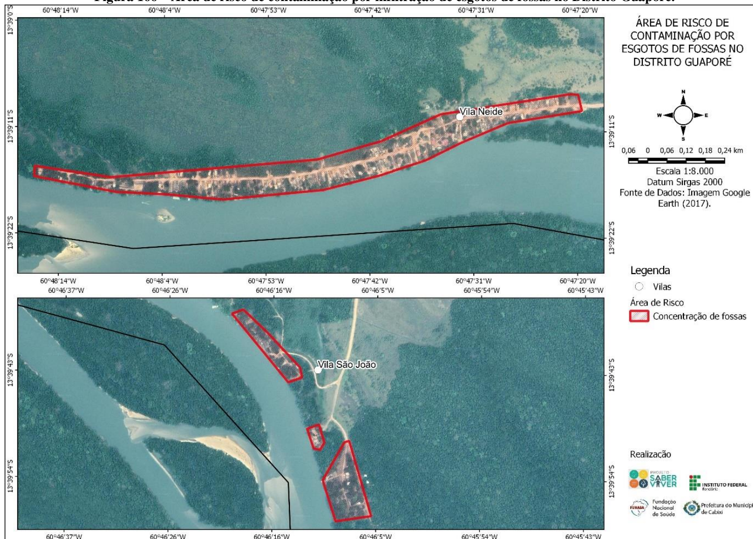
Figura 166 – Área de risco de contaminação por infiltração de esgotos de fossas no Distrito Guaporé.
