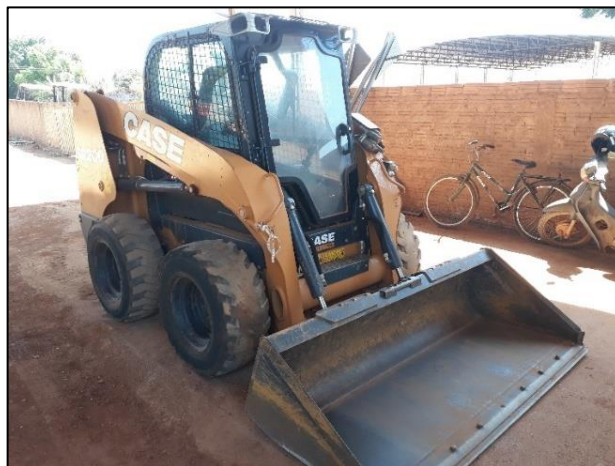
Figura 235 - Minicarregadeira CASE SR200, utilizado nos serviços de limpeza pública.
