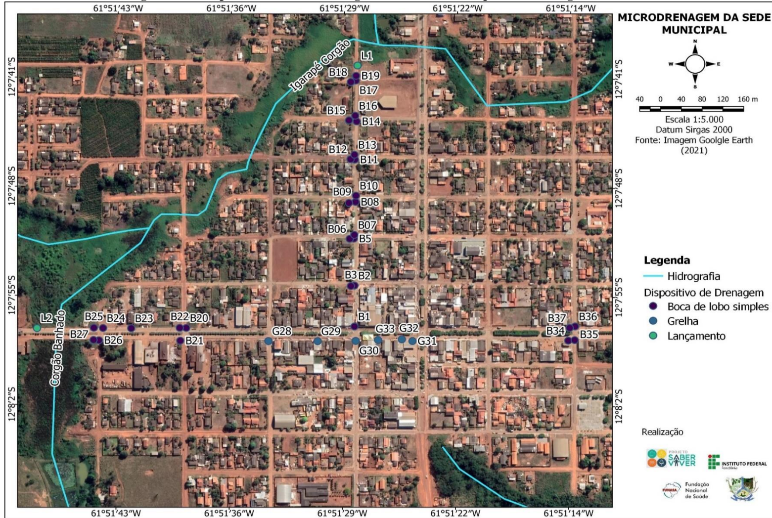
Figura 188 - Dispositivos de microdrenagem na sede do Município de Alto Alegre dos Parecis
